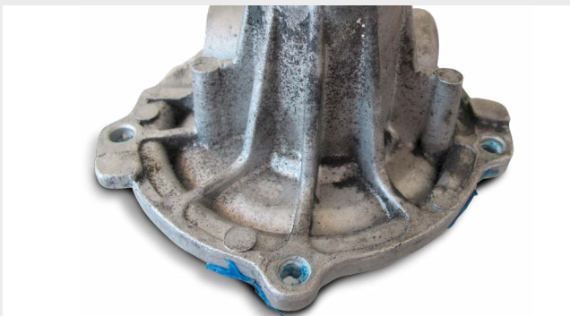
Dommages de palier dû à des problèmes de courroie (fragments de caoutchouc, particules sur le boîtier)
