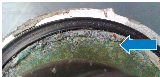
Un liquide de refroidissement inapproprié a occasionné une corrosion et des fuites
